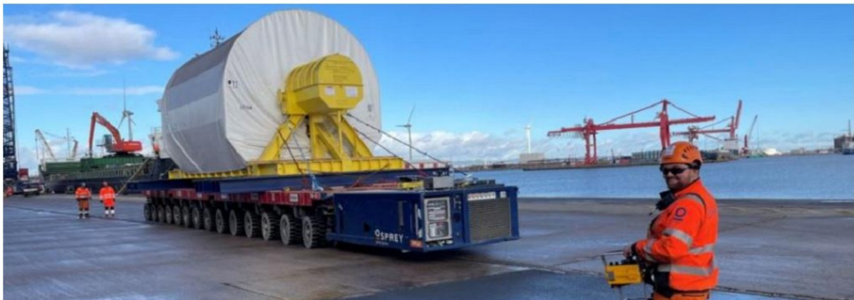
Figuur 5-16: Transport van grote, zware en ondeelbare onderdelen, in dit geval de rotor van een stoomturbine bij Hinkley Point C (Bron: Mott Macdonald, 2025b).
